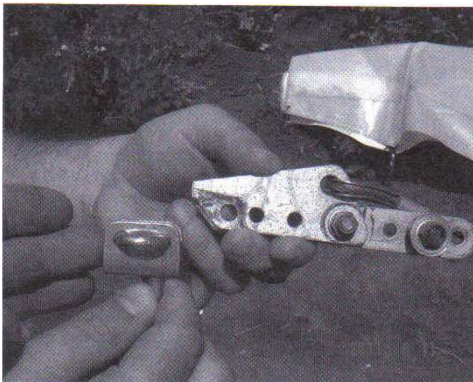
Obr. 1 – Deštrukcia duralového telesa napínaču Uverejnené v časopise Pilot LAA ČR, 7/2011.
